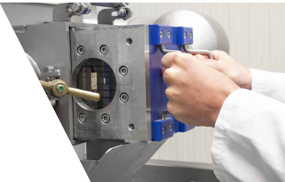
Gemakkelijk verwisselbaar messenblok
