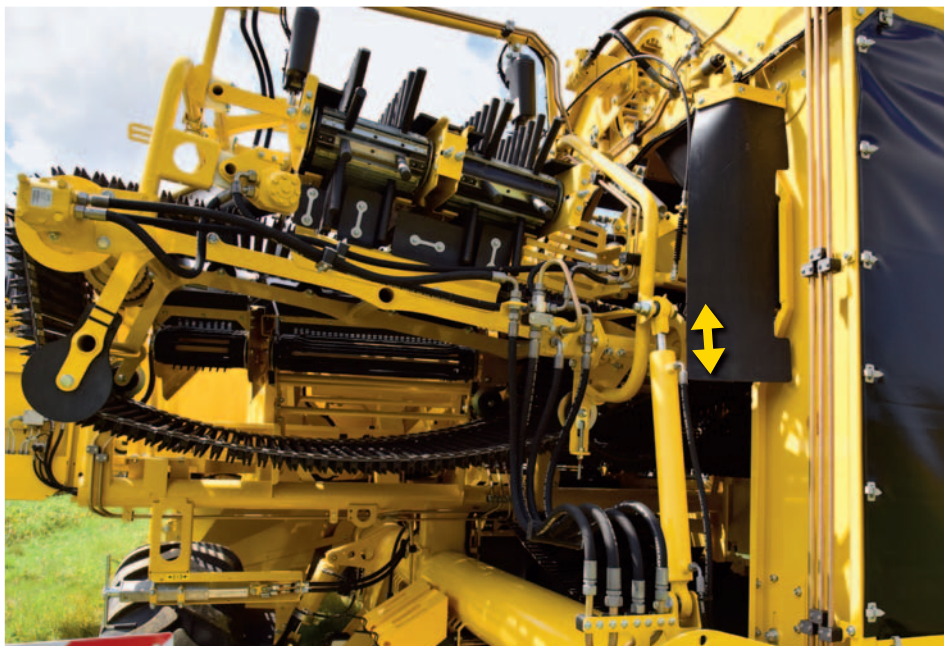
Compensation automatique de l'inclinaison des tapis à têtes 1 et 2
