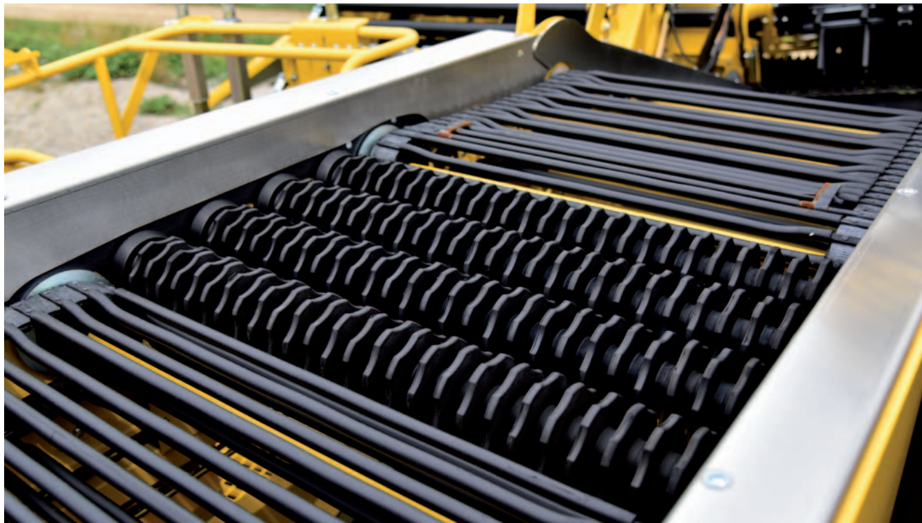
Rouleaux de séparation réglables en continu de 25 à 40 mm
