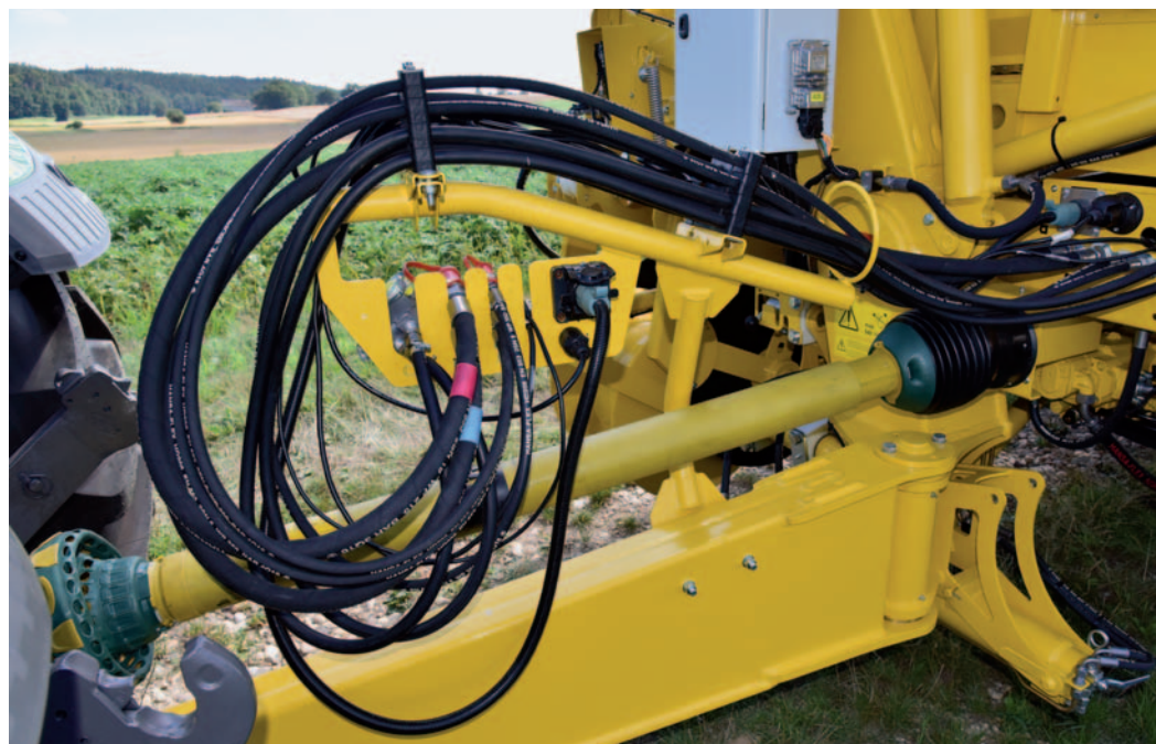
Agencement des flexibles et câbles pour le stationnement
