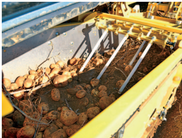
Agitateur pour une meilleure séparation des pommes de terre et des fanes
