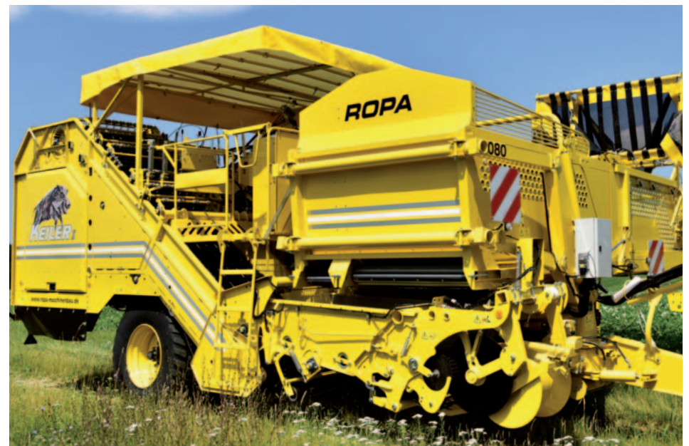
Toit de protection du soleil (en option, extensible aux côtés de la table de visite)
