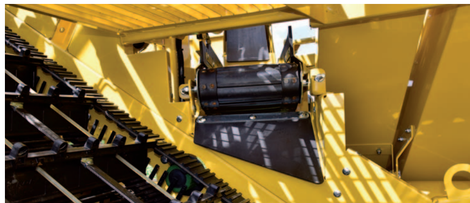
Tapis de récupération des déchets sur la chaîne de tamisage 2
