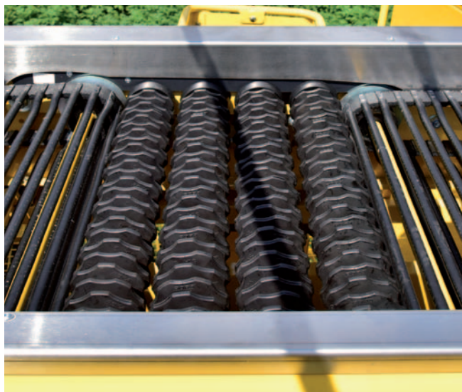
Rouleaux de séparation réglables en continu de 25 à 40 mm
