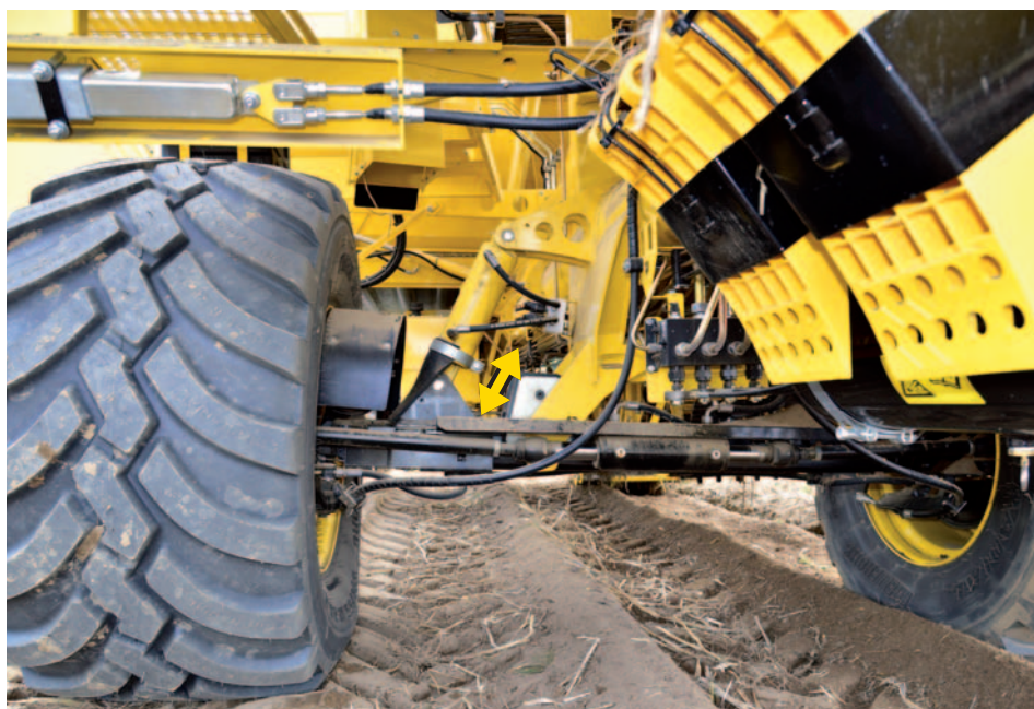
Compensation hydraulique et automatique de l'inclinaison de la machine
