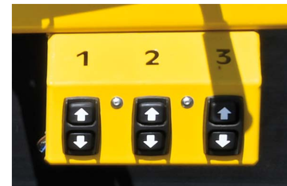
Réglage de la hauteur des rouleaux déviateurs à l'aide de commandes électriques
