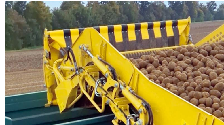
Remplisseur de caisses à repliage hydraulique sur la trémie à bras de chargement
