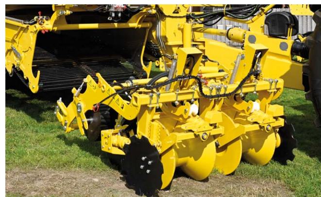
Bâti à diabolos avec disques crénelés des deux côtés
