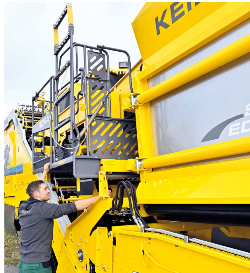
Plateforme de travail télescopique - Extension de 300 mm pour plus d'espace à bord tout en respectant le gabarit routier
