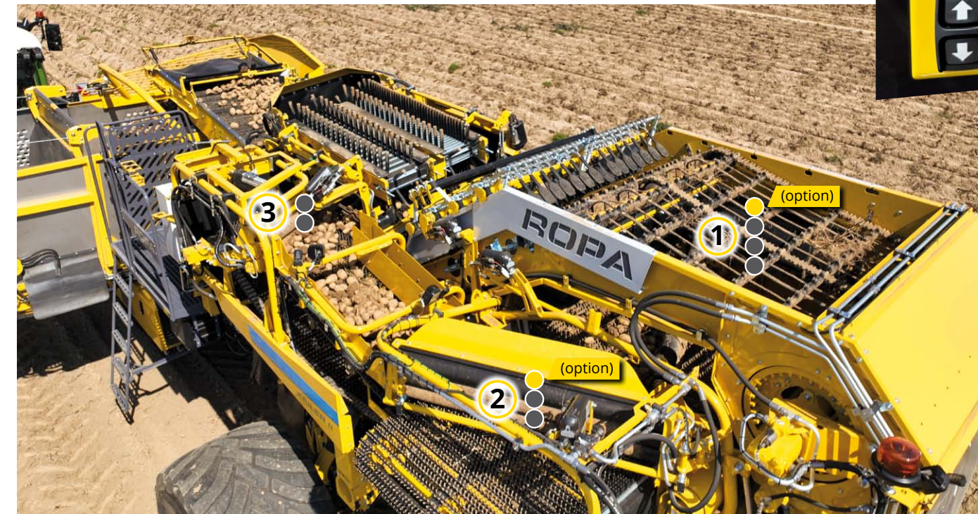
La hauteur et l'inclinaison des différents séparateurs peuvent être modifiés en continu, de façon hydraulique et électrique, par une simple pression sur un bouton
