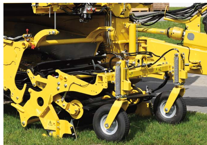
Bâti à diabolos avec disques crénelés des deux côtés
