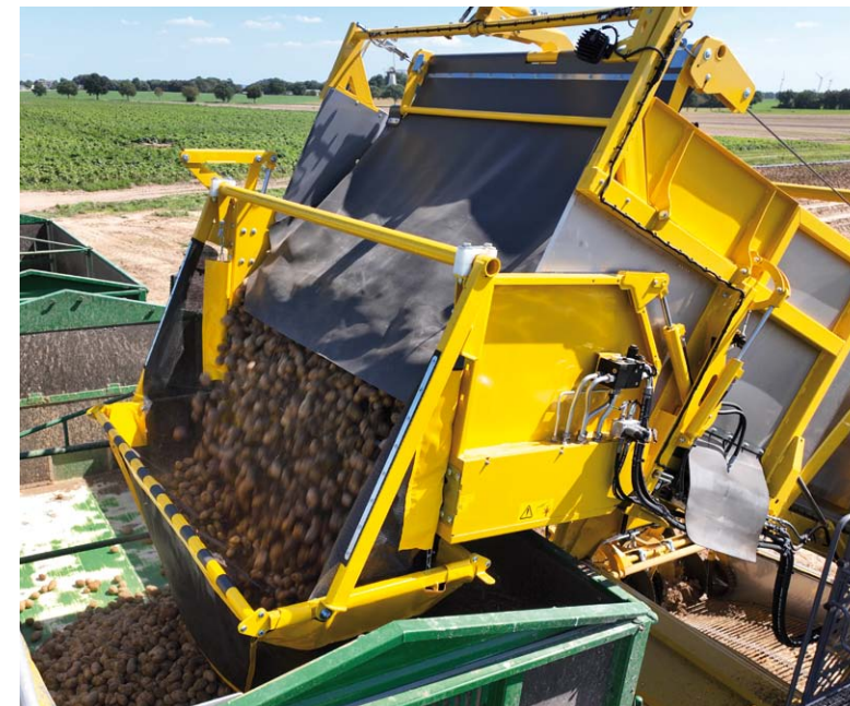
Remplisseur de caisses à repliage hydraulique sur la trémie à bras de chargement
