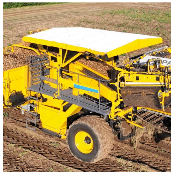
Toit pare-soleil, réglable en hauteur (en option avec filets brise-vent latéraux)
