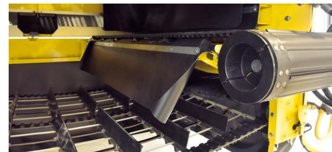
Tapis d'évacuation de la terre
