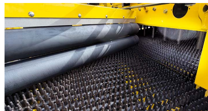
Jonction entre le tapis à tétines 3 et dans le séparateur à doigts
