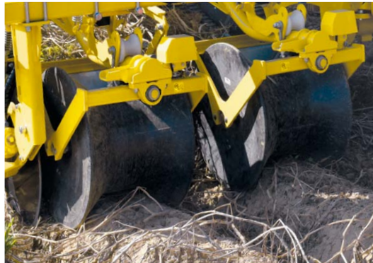
Diabolos en plastique, entraînement hydraulique du disque extérieur
