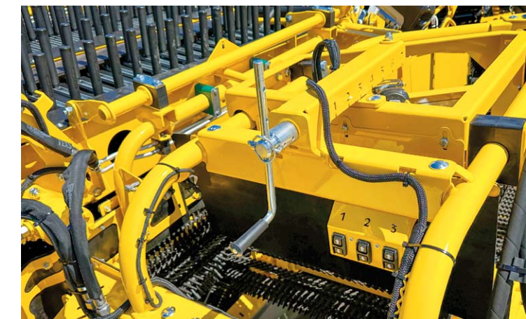
Levier de réglage d'ouverture des rouleaux déviateurs du tapis à tétines 3
