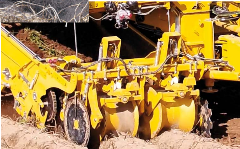
Disque crénelé à l'intérieur, disque supplémentaire à l'extérieur
