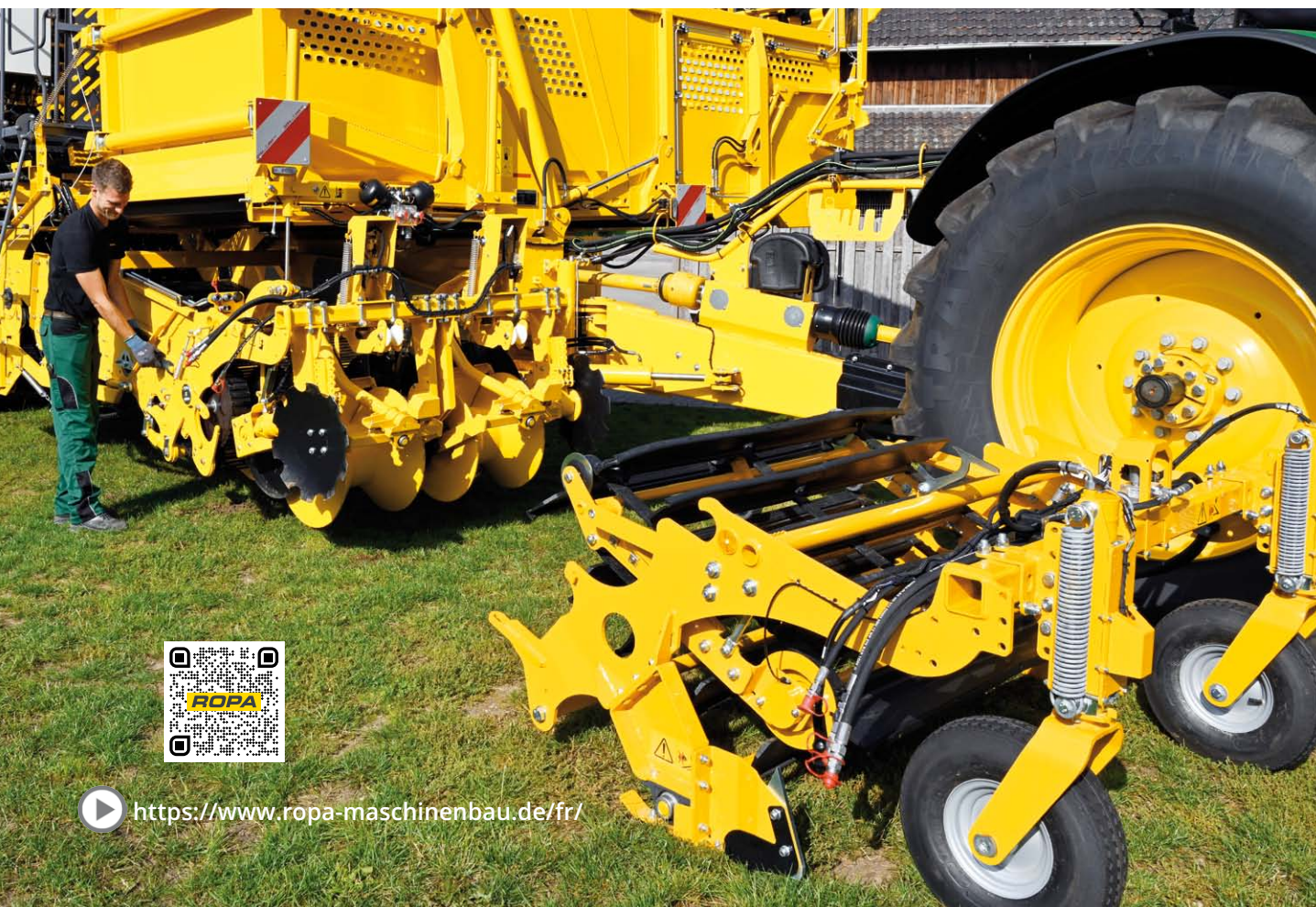
Bâti à diabolos avec disques crénelés des deux côtés
