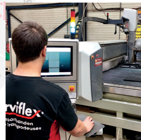
Rubber snijden met Waterjet
