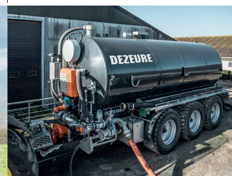
Dual line: voor transport en/of sleepslang, 20 tot 30 m 3
