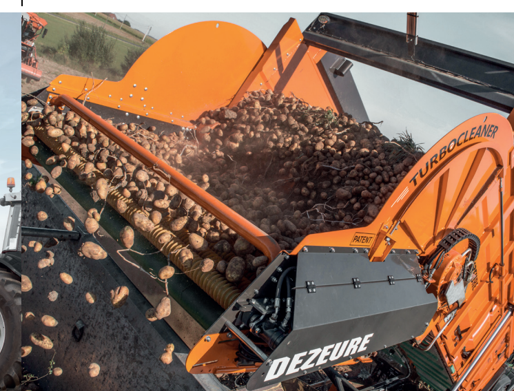
Turbocleaner: 12/13 spiraalrollen of sterrollen, aandrijving in 3-sets, autoreiniging
