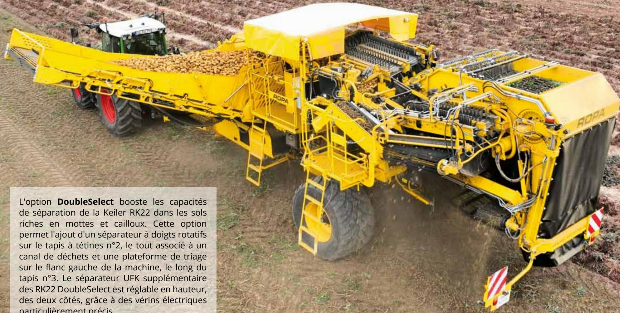
L'option **DoubleSelect** booste les capacités de séparation de la Keiler RK22 dans les sols riches en mottes et cailloux. Cette option permet l'ajout d'un séparateur à doigts rotatifs sur le tapis à tétines n°2, le tout associé à un canal de déchets et une plateforme de triage sur le flanc gauche de la machine, le long du tapis n°3. Le séparateur UFK supplémentaire des RK22 DoubleSelect est réglable en hauteur, des deux côtés, grâce à des vérins électriques particulièrement précis.
