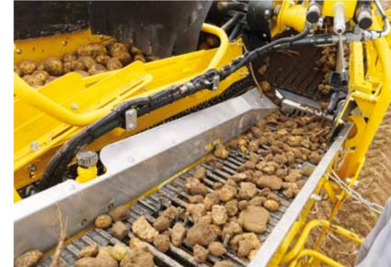
La séparation précoce des pierres et des mottes du flux de produit réduit considérablement les dommages causés aux pommes de terre, ce qui permet de récolter les tubercules encore plus délicatement. Chaque UFK peut également être équipé, en option, de brosses rotatives (UBK).
