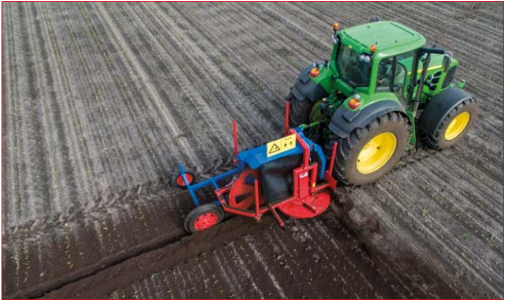
ZIBO Sleuvenfrees met horizontale wegwerpschijf (SF0335) en twin wielstel (SF0615)
