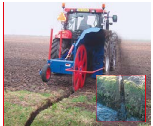
ZIBO sleuvenfrees met steunwiel (SF0315) en hydraulische diepteregeling (SF0316)
