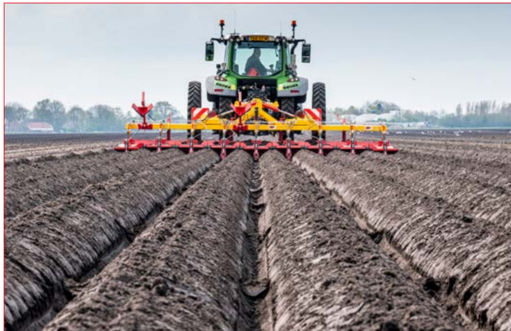
Rugvormer met tussenplaten met V-trekker (RS75) en erosiekleppen (RS1058) voor opkomst.
