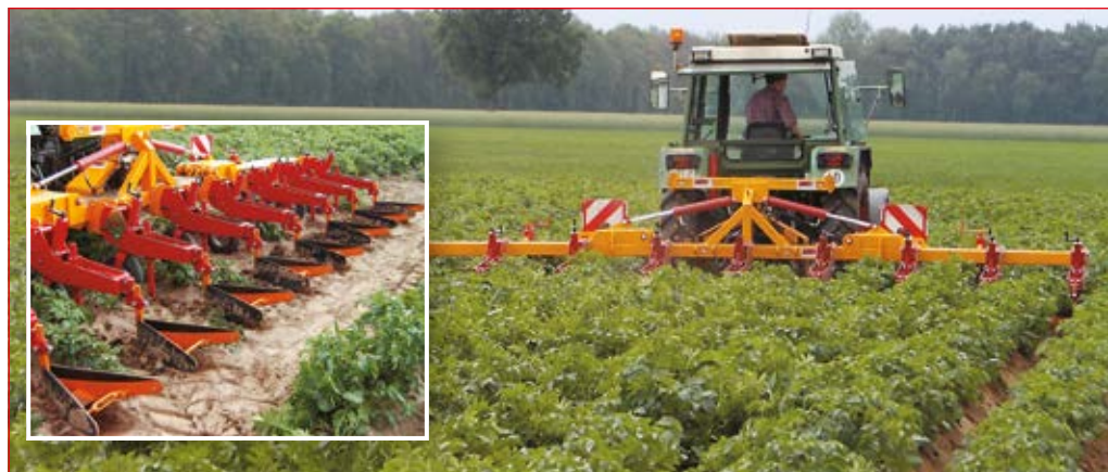
Inzet: ZIBO schoffelbalk 8 rij met ZIBO Super aanaarders met glijplaten
