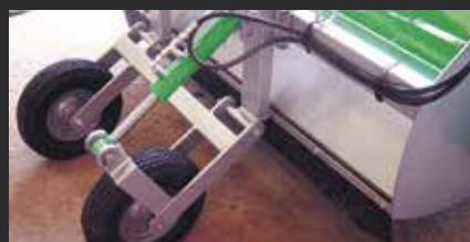
Mise à hauteur hydraulique
