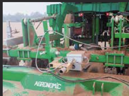
Mise à niveau automatique de la cape
