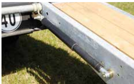
Opritten standaard met veerondersteuning als optie ook hydraulisch verkrijgbaar
