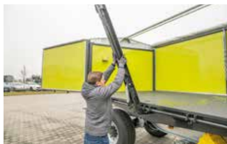
Uitneembare ringen voor probleemloos laden en lossen
