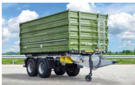
TDK 160 met opbouw 1800 mm (3 x 600 mm schottenwand)
