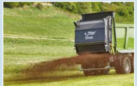
Met de breedstrooier met schotel varioSPLASH zijn strooibreedtes tot 32 m mogelijk.
