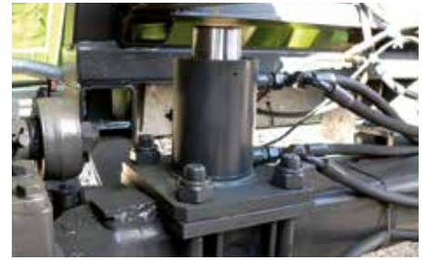
Optie: Hydraulische ondersteuning op de as
