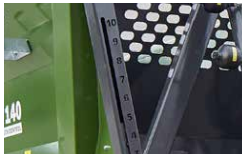
De schaalverdeling aan de voorkant geeft de openingspositie van de guillotinedeur aan.
