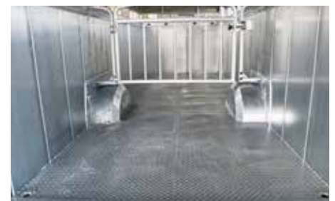
Ribbelplaat zorgt ervoor dat dieren stabiel staan
