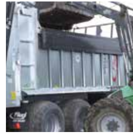
Mechanisch neerklappen van zijwanden
