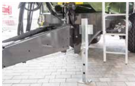
Vanaf TMK 256 standaard: Hydraulische disselvering en valsteun- poot, mechanisch Vanaf TMK 256
