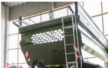
Mechanisch opklapbaar beschermrooster
