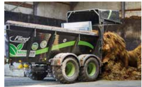
De ADS is optioneel te voorzien van een groot volume achterwand 800mm en kan als transportaanhanger benut worden
