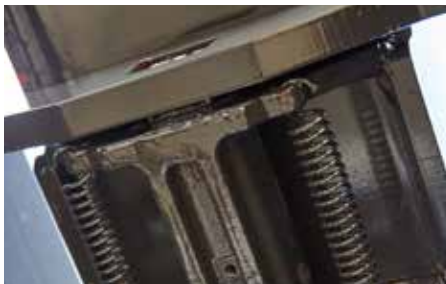
Automatische haakvergrendeling tijdens het kiepen
