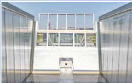
Afdichtstrips: De speciaal onder een hoek van 45° aangebrachte polyuretaanstrips in de laadruimte dichten deze perfect af.
