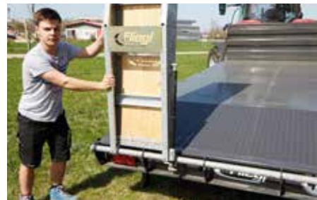
Praktisch: verschuifbare oprijrampen voor aanpassing van de spoorbreedte
