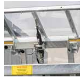
Roosterwandverhoging: mechanisch in de standaarduitrusting of optioneel hydraulisch verstelbaar.
