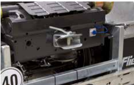
Optie: Uittrekbare verlichtingsdrager, remaansluiting en hydraulica voor 2e aanhanger
