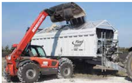
ASW 373 Tiger met beschermrooster tegen vreemde voorwerpen
