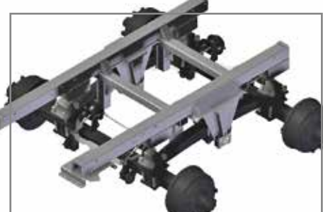
Met Titan onderstel in tandemmassige uitvoering voor optimale compensatie van bodemoneffenheden.
