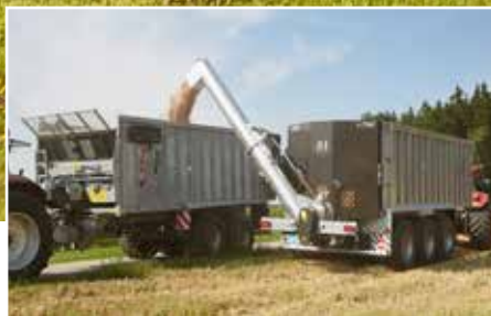
Overlaadschroef ÜLS 400 voor graan Overlaadcapaciteit ca. 7,5 ton/min
