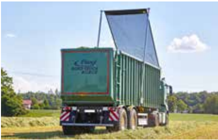
Optrekken door veerspanning
