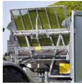
Afschuifwand „Insight“ met groot venster uit slagvast materiaal voor de beste doorkijk
