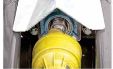
Boordhydrauliek 60 liter (optioneel 90 l) aangedreven door aftakas met hydraulische pomp en olietank
