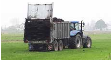
Strooier "Profi V2n" Voor afschuifwagen met 1500 mm bakhoopte
