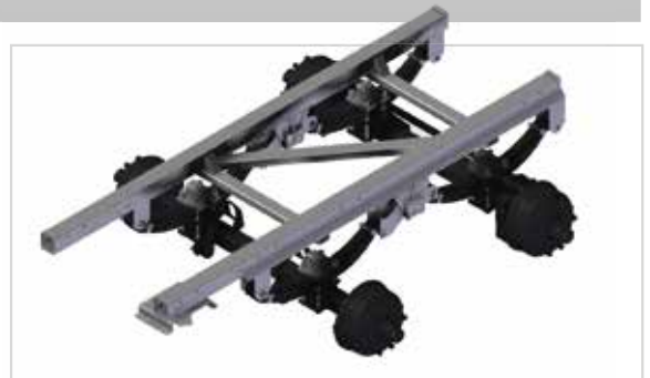
Gigant – Tandemasser met parabolische vering
