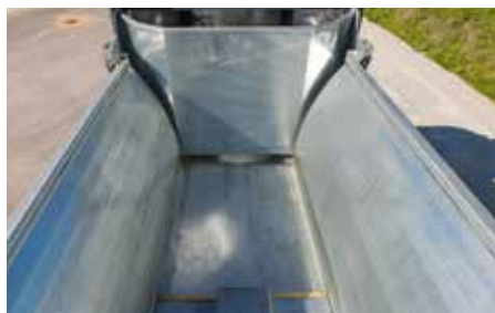
Geringste slijtage door het hydr. schuif-systeem – geen schraapbodems.
