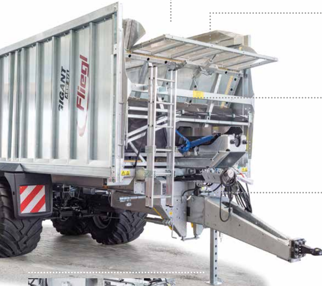
Grootvolume achterwand met graanschuif, standaard leverbaar
