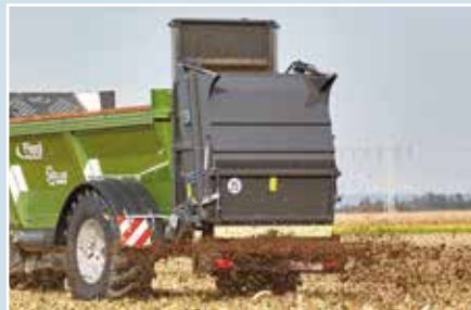
Met de breedstrooier met schotel varioSPLASH zijn strooibreedtes tot 32 m mogelijk.
