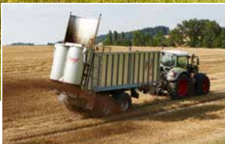
Strooiwerk PROFi V2 met werpschotel en werpendel
