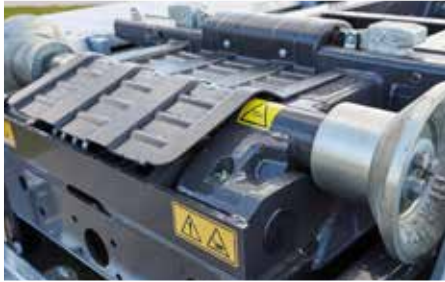
Grote aflooprollen uit gietstaal (Ø 310mm) met grote oplopende centrering vereenvoudigen het optrekken van de container.
