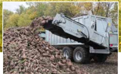
Overlaadbands RUBY voor suikerbieten Overlaadcapaciteit ca.: 15m 3 /min
